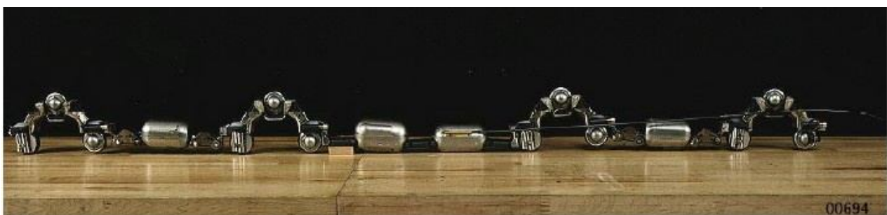
Figura B.6. – Sistema robotizzato per la posa dei cavi
