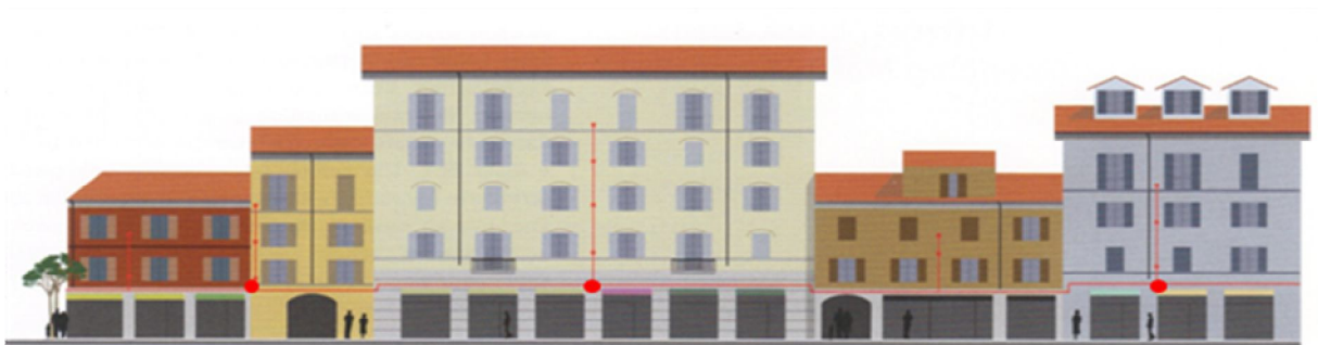
Fig. B.19 - Cablaggio in facciata di edificio
